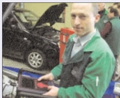
„Das **DiScan 8000** von **AVL** ist technisch identisch mit dem Reflex 3130. Lediglich das Gehäuse und die Anordnung der Bedientasten ist geändert. Funktionalität und Menü-Ablauf sind daher gleich. Der etwas klobige und relativ schwere Tester ist absolut werkstatttauglich.“
